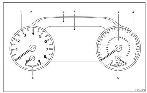
SPEEDOMETER AND ODOMETER
